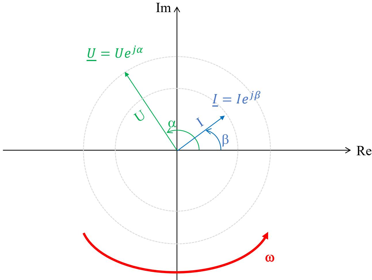
L'impédance complexe  $\underline{Z}$  d'un dipôle associé à une fréquence donnée en régime permanent sinusoïdal est le quotient de la tension par le courant complexe
